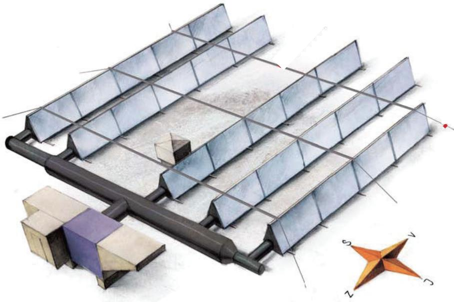
Fig. 3. Fila de colectores de aire industriales SolarVenti conectados en serie
