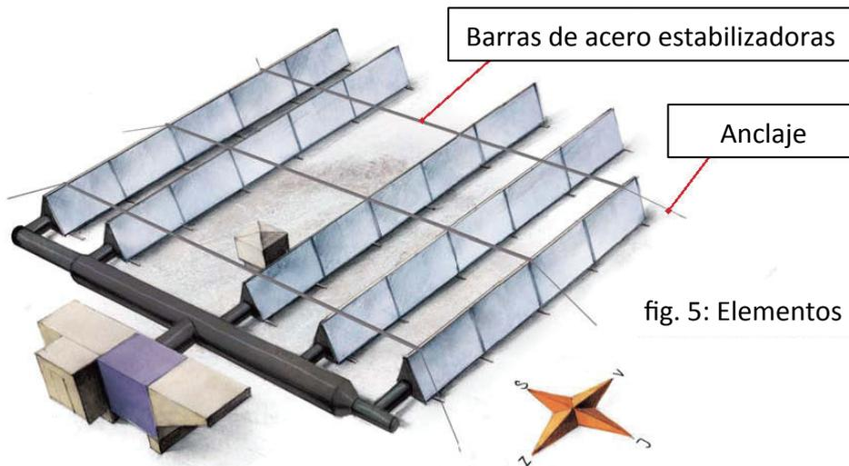
fig. 5: Elementos de fijación al tejado
